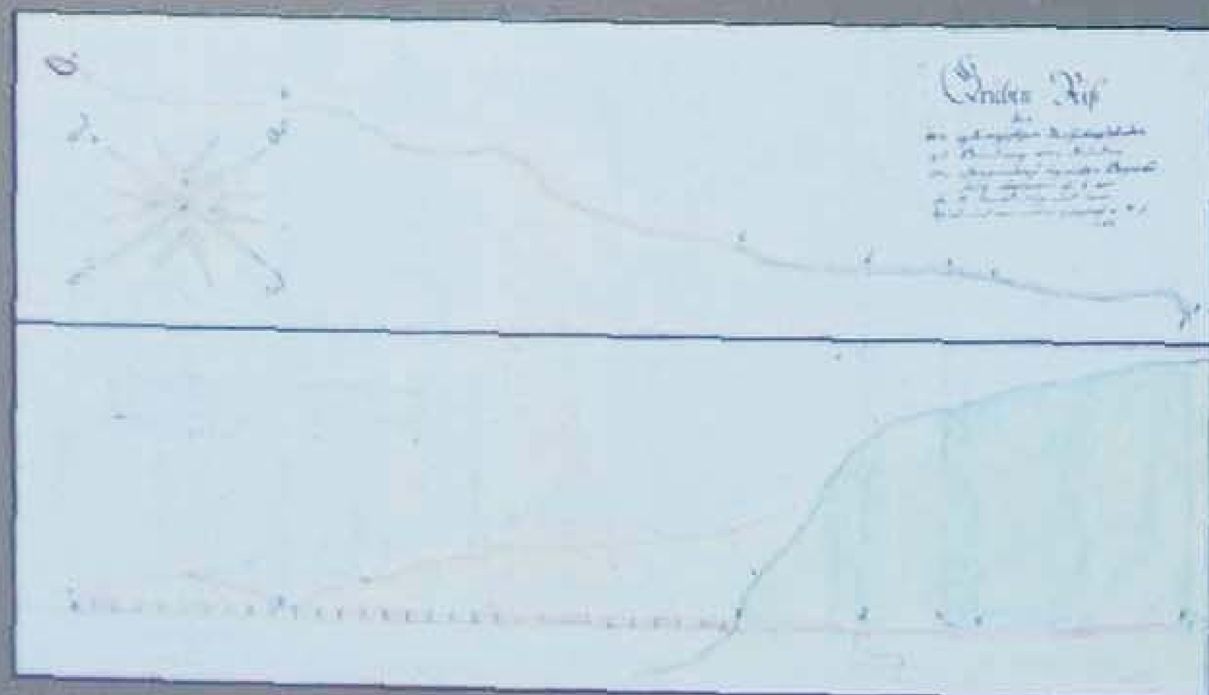
Die Zeichnung von 1787 zeigt den Stollenverlauf in der Aufsicht (oben) und im Querschnitt (unten) durch den Berg. 1996 wurde der Stollen bis zu einer Länge von 60 m zugänglich gemacht und erneuert, insgesamt ist er vermutlich ca. 400 m lang.
